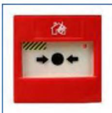
Ручной извещатель (пожарная кнопка) «ИПР-Р» – установлены на путях эвакуации у выходов из коридоров на лестничные площадки и улицусогласно проекта АПС. Позволяет в случае пожара сформировать извещение ПОЖАР нажатием на кнопку извещателя; нажатие индицируется визуальным индикатором (черно-желтые полосы) и световым индикатором (красные вспышки).
