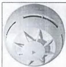
Дымовые извещатели (датчики) «Аврора-ДР» - установлены во всех помещениях объекта, подлежащих защите АПС согласно проекта. Контролируют наличие дыма в защищаемых помещениях. При задымлении формируют извещение ПОЖАР, на датчике включается световая индикация проблескового типа (вспышки красного света);
