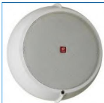
Речевые оповещатели «Орфей-Р исп.2» - установлены в кабинетах и коридорах объекта согласно проекта АПС. При формировании АПС извещения ПОЖАР воспроизводят записанное речевое сообщение: «Внимание, в здании пожар! Просьба покинуть здание через ближайший выход». До сброса пожарной тревоги оповещатели можно локально отключить. Для этого повернуть оповещатель на небольшой угол против часовой стрелки и снять с основания.
